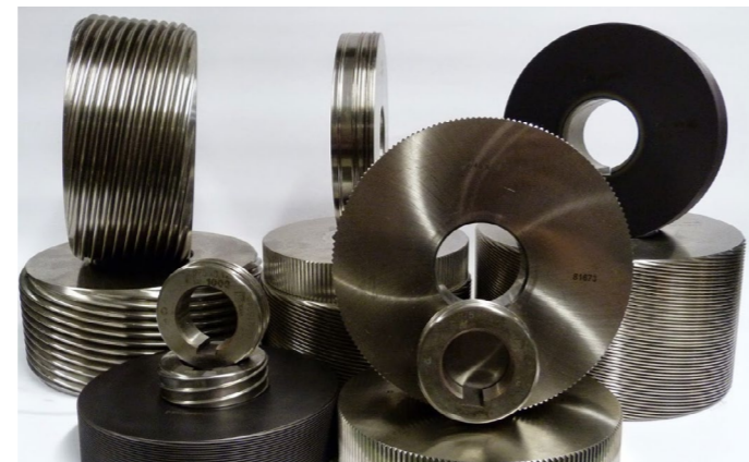
Široká nabídka nástrojů na válcování závitů a profilů. Výrobce nabízí jak nové válcovací nástroje, tak repasi nástrojů různých výrobců.
