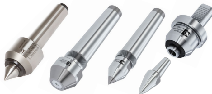
Otočné a pevné hroty NEIDLEIN lze nabídnout v různých standardních a speciálních provedeních, s přesností obvodového házení až max. 0,002 mm ve variantách pro soustružení nebo broušení, s pevným, odpruženým nebo vyměnitelným hrotem.
